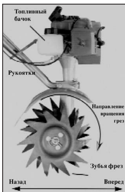
Положение культивирования: Зубья фрез смотрят против вращения, т.е. назад, к оператору.
