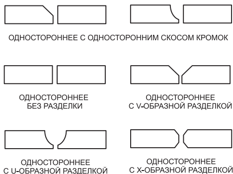
Рис. 14. Виды стыковых соединений
