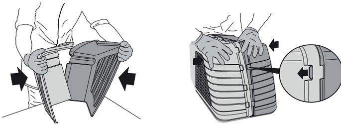
Для установки травосборника на косилку нужно поднять заднюю крышку и закрепить травосборник за выступы на корпусе.
