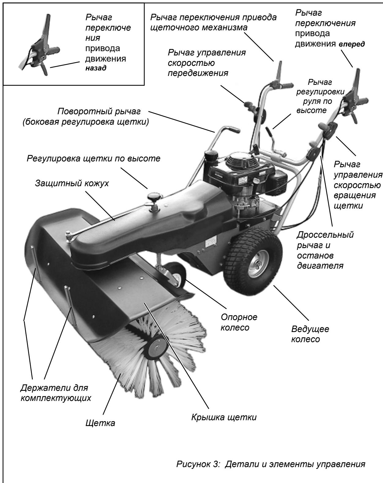
Рисунок 3: Детали и элементы управления
