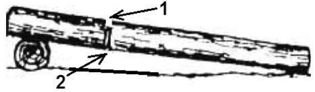
Рис. 11. Пропилы при раскряжевке дерева на одной опоре
