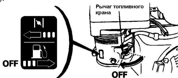
Рисунок 12 – Рычаг топливного крана в положении "OFF" ("Выключено")
