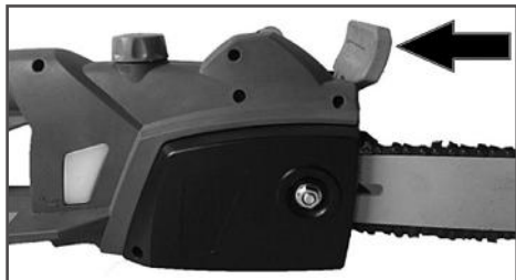
Рис. 7 Отключение тормоза цепи
