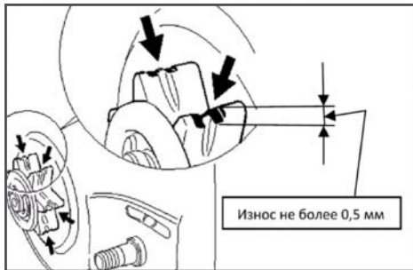
Рис. 14 Проверка износа звездочки
