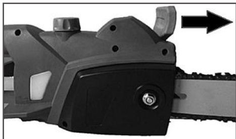
Рис. 8 Включение тормоза цепи
