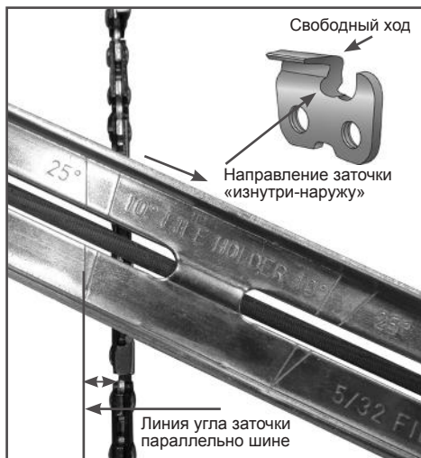
Рис. 16 Определение угла заточки
