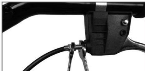
Рис. 12 Фиксация троса газа
