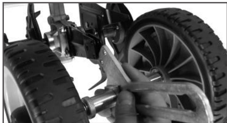
Рис. 6 Установка кронштейна колес
