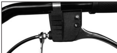
Рис. 10 Установка регулировочной муфты троса газа
