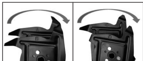
Рис. 3 Маркировка и направление вращения фрез
