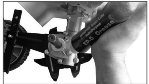
Рис. 24 Добавление смазки в корпус редуктора
