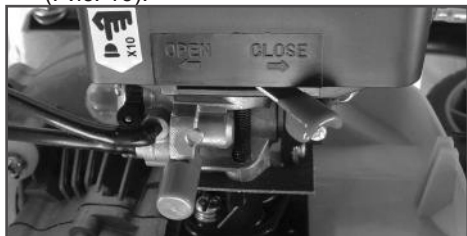
Рис. 16 Воздушная заслонка карбюратора закрыта
