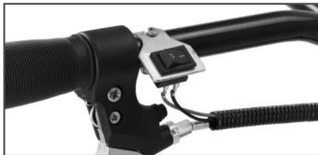
Рис. 13 Подключение проводов к выключателю зажигания
