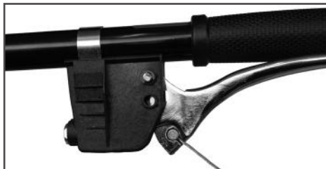
Рис. 9 Установка наконечника троса газа
