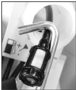
Рис. 21 Извлечение топливного фильтра
