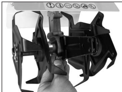
Рис. 5 Установка кронштейна сошника
