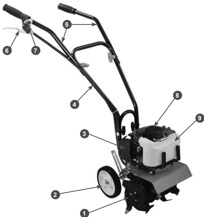
Рис. 1 Основные узлы и органы управления. Вид спереди
