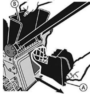
Рис. 5 Установка заглушки для мульчирования
