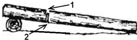
Рис. 11. Пропилы при раскряжевке дерева на одной опоре
