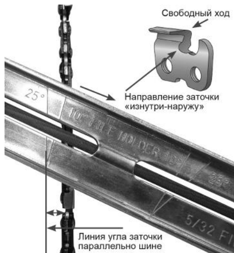
Рис. 15 Определение угла заточки
