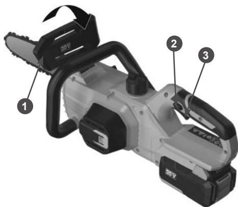
Рис. 5. Расположение органов управления на задней рукоятке
