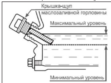
Рис. 15 Проверка уровня масла в картере
