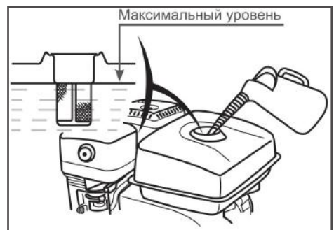
Рис. 16 Максимальный уровень топлива в топливном баке
