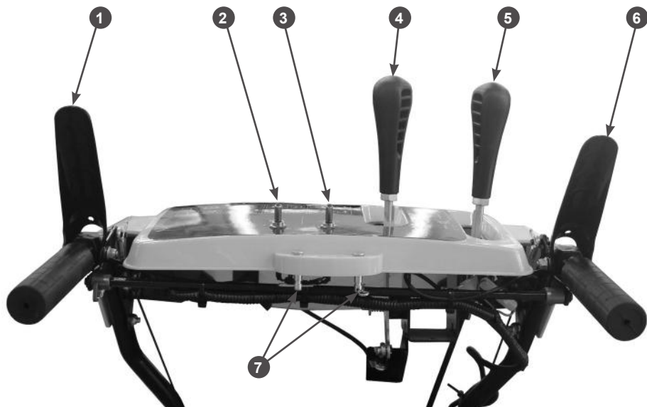
Рис. 3 Основные узлы и органы управления (вид на панель управления со стороны оператора)
