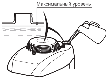
Рис. 7 Максимальный уровень топлива
