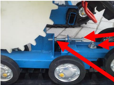
5. По необходимости натянуть гусеницы производить натяжником, перед этим ослабив гайку. После натяжки, гайку затянуть до упора и законтргаить натяжной болт (провис гусеницы max 25мм)
