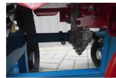
4. Установить переднюю рамку на корпусе ГУСЕНИЧНОГО ПРИВОДА. До упора затянуть болт крепления рамки.
