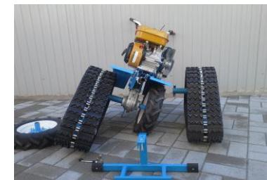
3. Болт обязательно нужно затянуть, чтобы сжалась резиновые втулки. Втулки служат амортизаторами. Что бы в соединении не было люфта, гайка должна быть с пластиком
