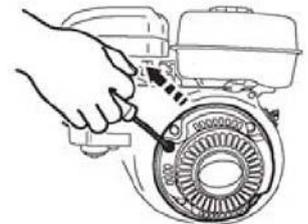
После запуска двигателя, постепенно переведите рычаг воздушной заслонки в открытое положение. Прогрейте двигатель без нагрузки в течение нескольких минут.
