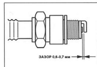
(б) Отрегулируйте зазор между электродами до 0,6-0,7 мм.
