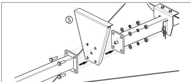
2 Установка подпорки между прицепной и кузовной балкой.
