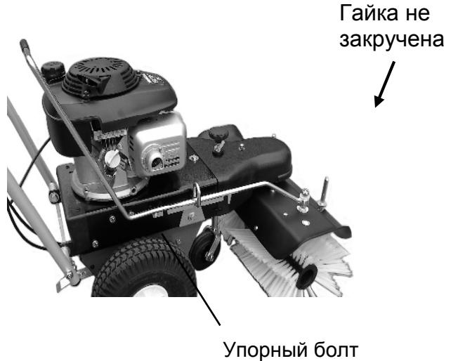
Внизу опорной планки необходимо закрутить болт M6x20 со самостопорящейся гайкой (как изображено на рисунке), при этом резьба направлена к машине. Этот болт служит в качестве упора.
