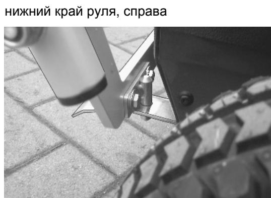
Протяните поворотный рычаг за ручку через петлю на правой стороне машины, а затем подведите его к болтам с винтовой нарезкой, расположенным на крышке щётки. Сверху и снизу места крепления находятся металлические шайбы. Вверху расположена пластмассовая шайба, с помощью которой фиксируется самостопорящаяся гайка, но закручивается не плотно, а свободно.
