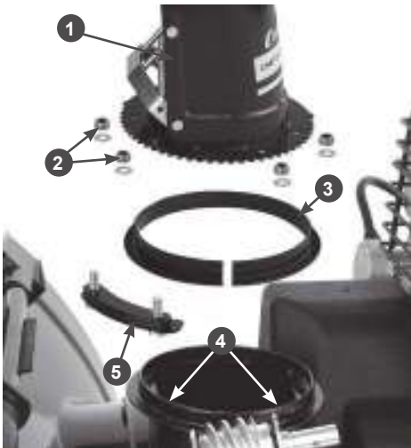
Рис. 19 Установка жёлоба выброса снега
