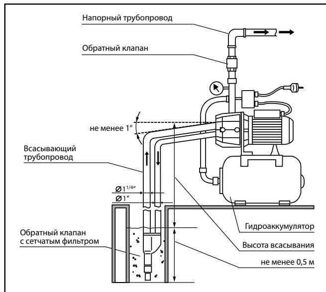
Чтобы избежать протечек и потери давления, соединения трубопроводов должны быть абсолютно герметичными. Соединение насоса с трубопроводами должно осуществляться без перекосов, чтобы внутреннее напряжение в трубопроводе не создавало препятствий для нормальной работы насоса.
