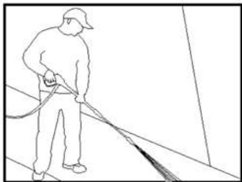
Рис. 6 - Оптимальный угол распыления воды относительно поверхности
