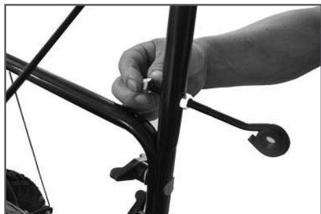
Рис. 13 Монтаж кронштейна рычага поворота желоба
