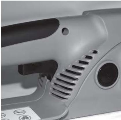
Грязные ребра воздуховодов двигателя могут стать причиной его перегрева и поломки. Регулярно очищайте от загрязнений ребра воздуховодов кисточкой и/или сжатым воздухом.
