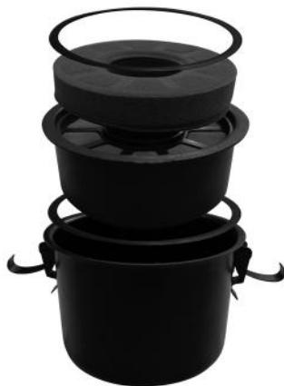
Рис. 21 Установка воздушного фильтра в стакан воздухоочистителя
