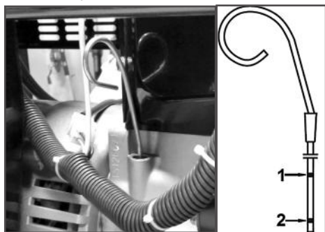
Рис. 8 Проверка уровня масла в картере
