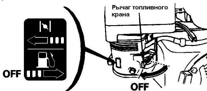
Рисунок 12 – Рычаг топливного крана в положении "OFF" ("Выключено")
