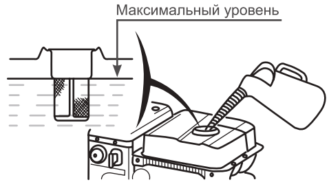
Рис. 11 Максимальный уровень топлива в топливном баке
