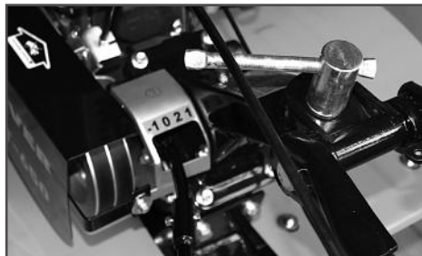
Рис. 16 Коробка передач мотоблока
