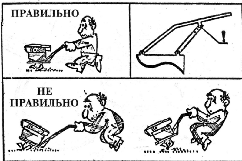
Рис. 10. Регулировка высоты руля.
