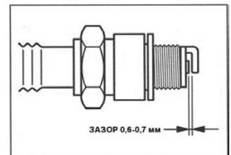
(б) Отрегулируйте зазор между электродами до 0,6-0,7 мм.
