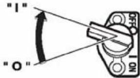
Переведите выключатель двигателя в положение "I" (ON - включено).
