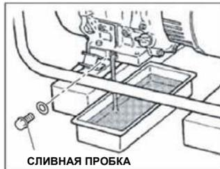
(б) Установите на место пробку сливного отверстия и залейте масло в картер, пока не будет достигнут максимальный уровень по пробке заливной горловины.
