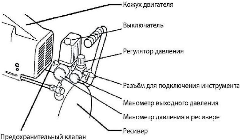
При достижении нижней установленной границы, автоматика включит двигатель для восполнения использованного воздуха. В модели КМ 0-150, при достижении максимального давления, срабатывает перепускной клапан, и излишнее давление сбрасывается, без прекращения работы двигателя. Будьте внимательны - данный компрессор не отключается самостоятельно. Для прекращения работы компрессора необходимо воспользоваться клавишей выключения на лицевой панели.
