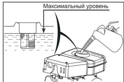
Рис. 8 Максимальный уровень топлива в топливном баке
