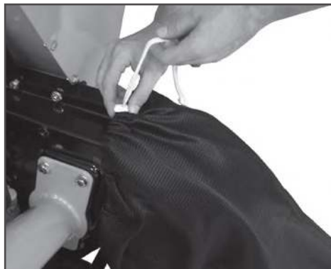
Рис. 4 Установка мешка для сбора продуктов измельчения
