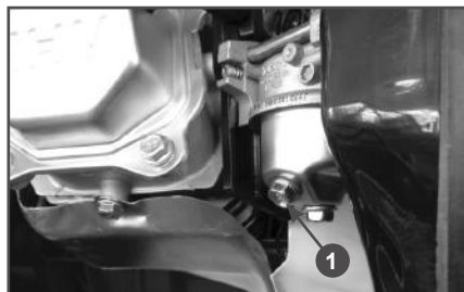
Рис. 16 Слив топлива из карбюратора
