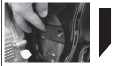
Рис. 23 Установка ножа измельчителя
