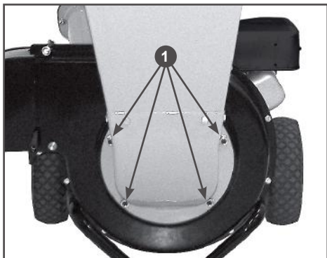
Рис. 25 Снятие воронки дробилки
